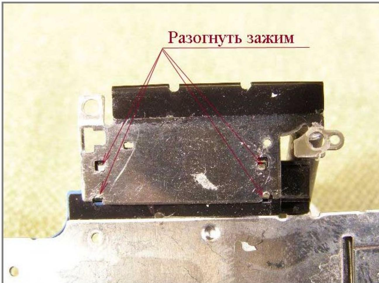
В этом креплении как раз и заключается ахиллесова пята данной конструкции. Из-за больших зазоров в креплении при перемещении движка переключателя происходит смещение корпуса этого переключателя относительно проводников ленточного кабеля. Но так как корпус переключателя сильно прижат к плате, а, следовательно, и к печатным проводникам, которые покрыты всего лишь тонким слоем лака, то со временем в результате ерзанья корпуса по плате этот лак протирается, и за лаком перетираются и проводники.
