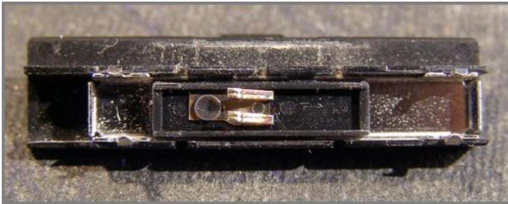
И вот, когда все предварительные операции были проделаны, пришло время основного действия, а именно, нанесения на поврежденные места токопроводящего клея. Перемешав основательно, в течение нескольких минут возделенную жидкость и вооружившись провололочкой диаметром около 0,3 мм., я взял тонкую палочку, опустил ее в клей, поднес эту палочку к плате и только затем, макая кончик проволоочки в капельку на палочке, начал восстанавливать дорожку.
