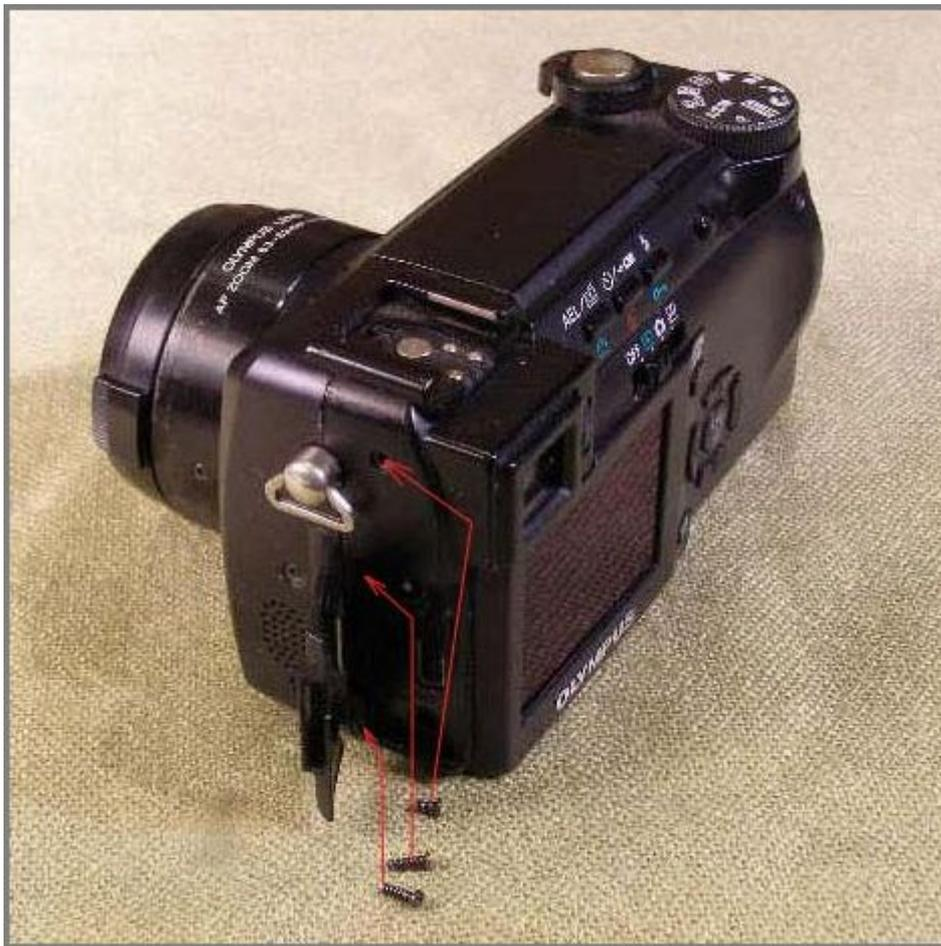
В частности, не сразу понял, что в горячем башмаке припрятаны, пять винтов и прежде чем до них добраться, надо отверткой немного отжать контактную скобу.
